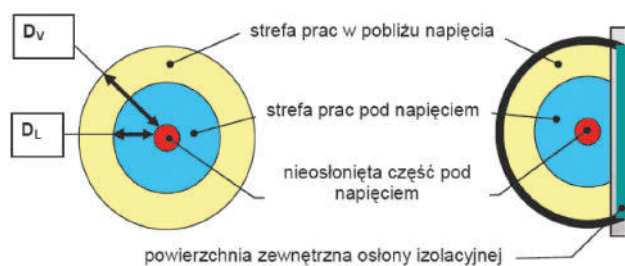
Rys. 2. Strefy prac wg PN-EN 50110-1 [4]
