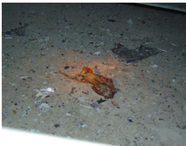
Rys. 12. Plamy stopionego aluminium oraz spalone szczatki gryzonia, który wywoal zwarcie
