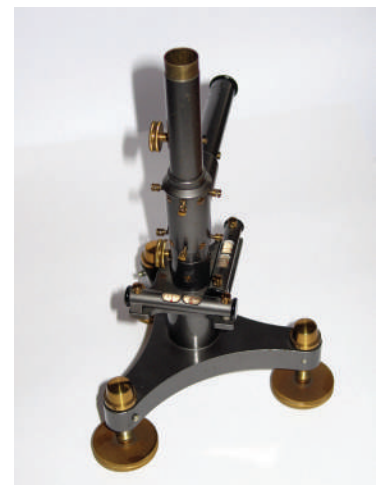
Pionownik szybu OTTO FENNEL SOHNE KASEL ok. 1800 r. shaft plumbing instrument, ca. 1800
