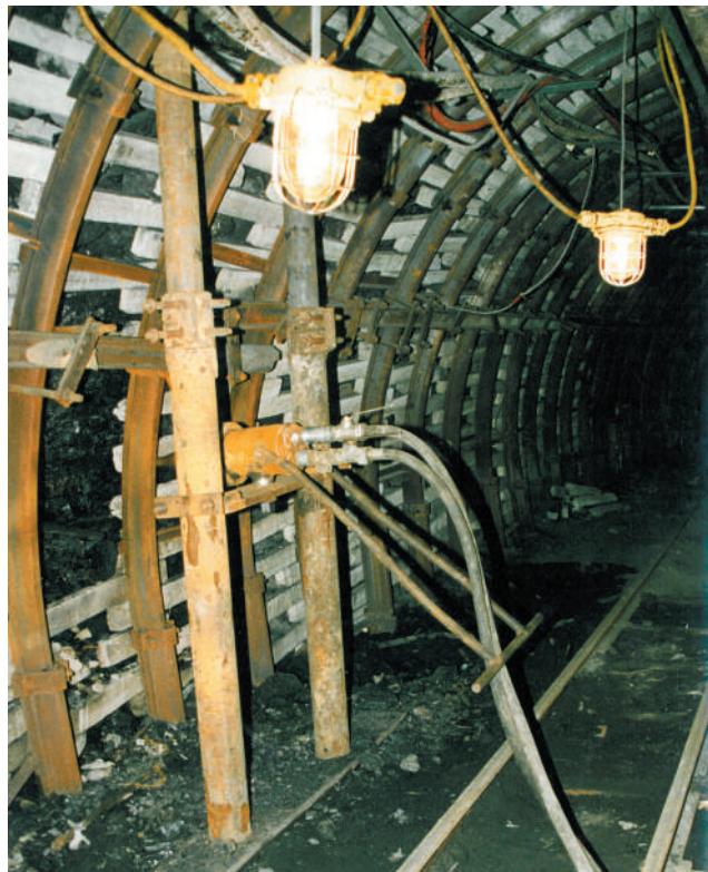
Fot. 3. Próba hydrocięcia węgla kamiennego w pokładzie 510 w chodniku transportowym w jednej ze śląskich kopalń
