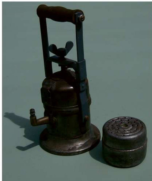
Rys. 6. Lampa karbidowa wyprodukowana przez firmę E. Hermann Hesse z Norymbergi w 1940 roku. Lampa ta pracowała w „systemie Jaworzno”, obok lampy puszka, tzw. „patrona”
