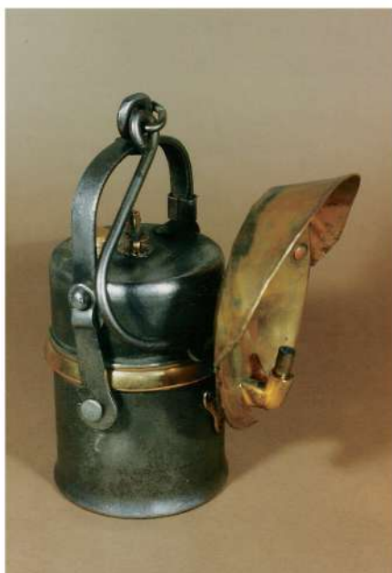
Rys 9. Lampa stalowa nadgórnika z odblaskiem, produkcji polskiej, lata 30. XX wieku
