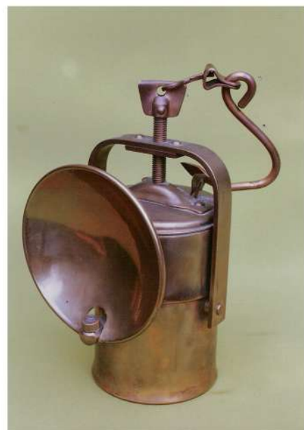
Rys 11. Lampa mosiężna sztygarska z odblaskiem i palnikiem umieszczonym centralnie na zbiorniczku wody, lata 40. XX wieku
