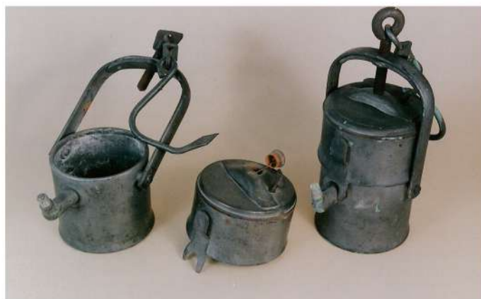
Rys. 8. Górnicze lampy karbidowe zamykane za pomocą śrubowego docisku zbiorników
