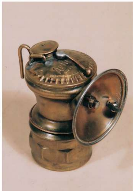
Rys. 4. Lampa górnicza acetylenowa nahlenna amerykańska, lata 30. XX wieku (czas świecenia 3-4 godzin)
