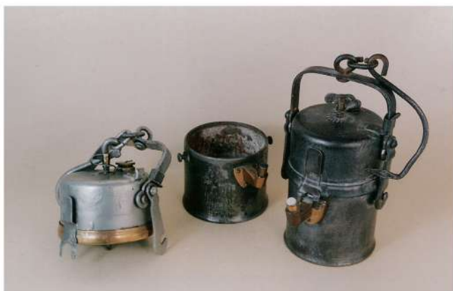
Rys. 7. Górnicze lampy karbidowe zamykane za pomocą hakowo-mimośrodowego łączenia zbiorników
