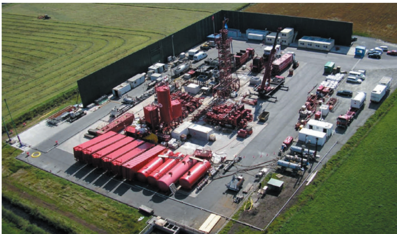
Rys. 8. Ekran akustyczny wokół odwiertu podczas szczelinowania hydraulicznego [10]
