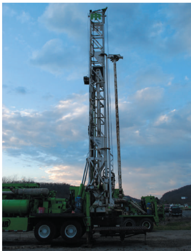
Rys. 2. Urządzenie wiertnicze używane do wiercenia otworów wertykalnych i horyzontalnych w formacji Marcellus Shale
