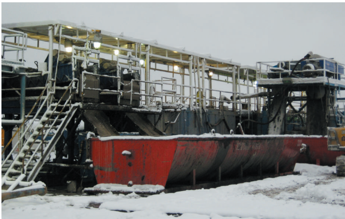
Rys. 2. System oczyszczania płuczki (m.in. zbiornik na zwierziny z sitami wibracyjnymi) w miejscu wiercenia otworu firmy Chesapeake Energy w rejonie Green Valley (USA); fot. B. Madej
