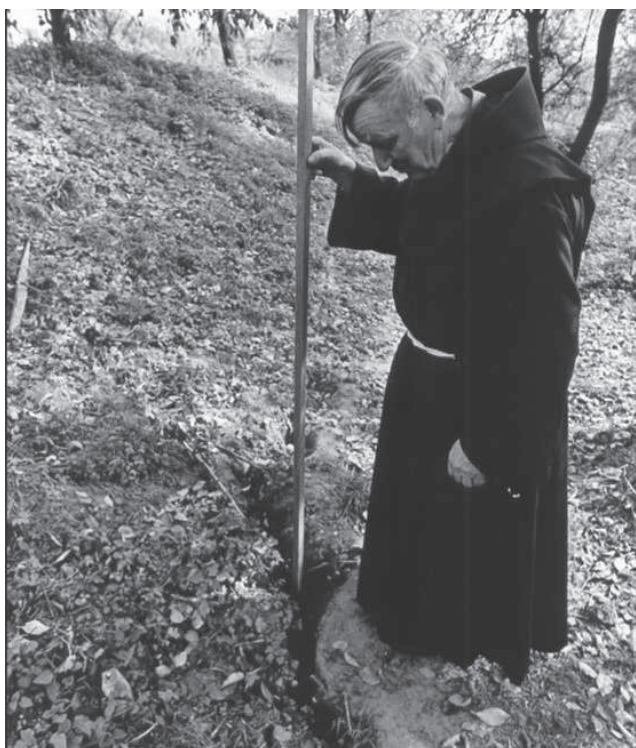
Rys. 4. Deformacje nieciągłe powierzchni terenu powstałe na terenie ogrodu klasztornego OO. Franciszkanów-Reformatów w Wieliczce (fot. P. Zechenter)
