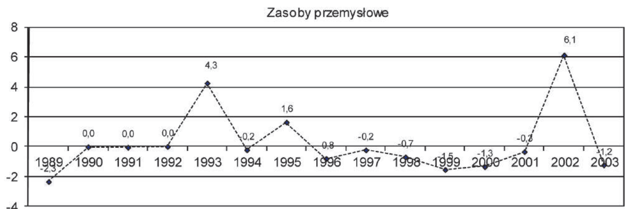
Rys. 4. Wskaźnik ubytku lub przyrostu zasobów przemysłowych w pokładzie 510
