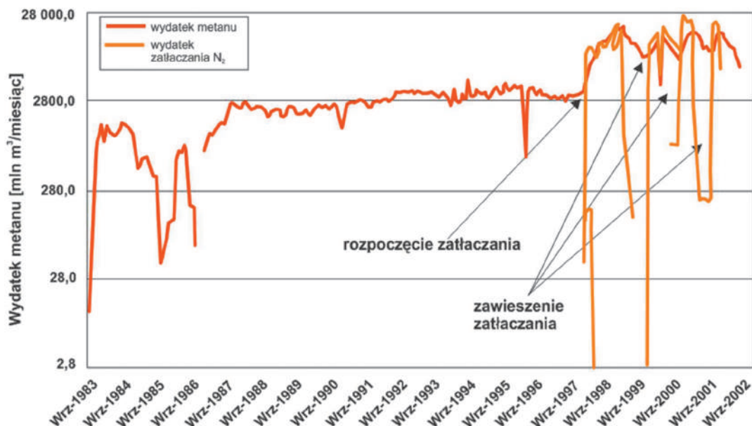
Rys. 3. Wydobywanie metanu i wydajność zatlaczania azotu – projekt N 2 -ECBM Tiffany, wg [9]
