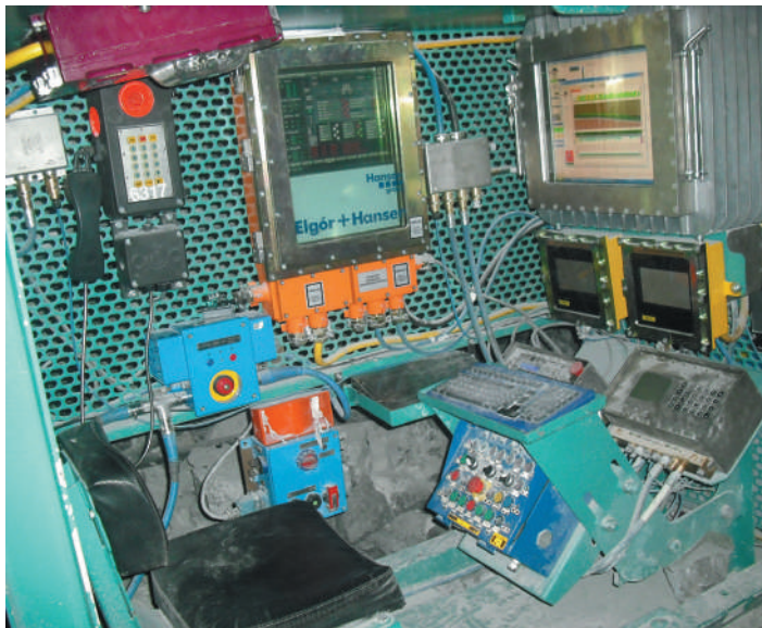
Rys. 3. Główne stanowisko sterujące kompleksem strugowym zlokalizowane w chodniku nadścianowym ściany 1/VI/385
