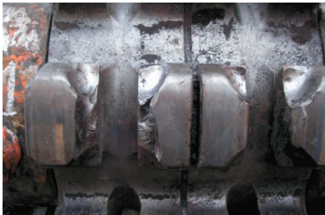
Rys. 7. Faza III zmęczenia – pęknięcie skrośne zębów bębna łańcuchowego, stan awaryjny
