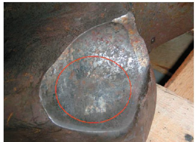
Rys. 9. Zużycie tribochemiczne zęba bębna łańcuchowego
