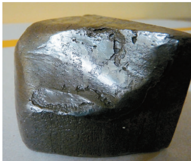
Rys. 10. Widok zęba bębna łańcuchowego z wykruszeniem materiału zainicjowanym powierzchniowymi pęknięciami pochodzącymi od zmęczenia cieplnego
