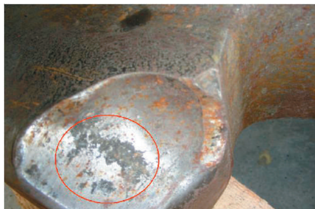
Rys. 1. Zużycie adhezyjne powierzchni roboczej zęba bębna łańcuchowego. Widoczne wyrwania fragmentów materiału z powierzchni roboczej zęba
