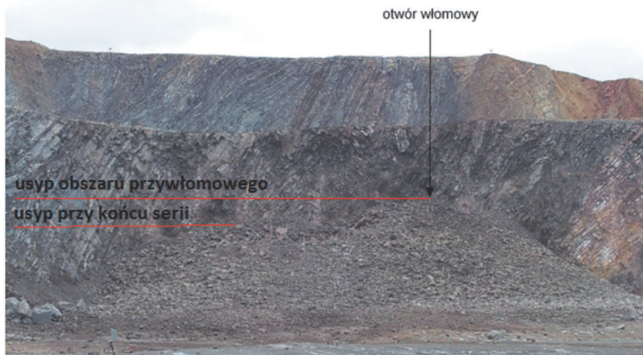
Rys. 1. Usyp urobku w przypadku włomu bocznego
